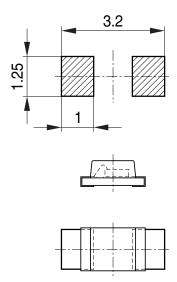
Bauteil positioniert Component location on pad OHFP2578
